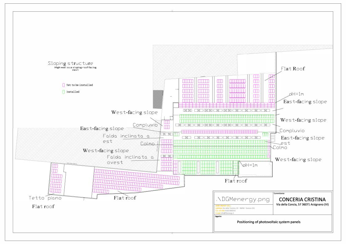
10,64KWP PHOTOVOLTAIC SYSTEM PANELS WITH 28 380WP PHOTOVOLTAIC MODULE
